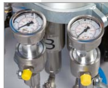
Измерительные устройства на выходе машины для компонентов А + Б
