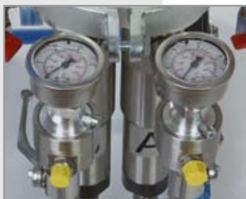
Измерительное устройство для контроля давления на выходе машины для компонентов А + Б
