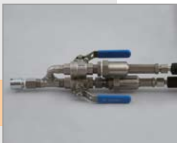
2-х компонентная смесительная головка из нержавеющей стали
