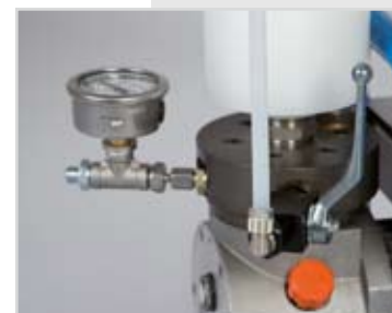
Рециркуляционный шланг с шаровым краном
